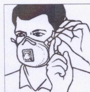
5. Bretele de tensionare poate fi redusă fără a scoate masca de respirat de pe cap, prin împingerea pe partea din spate a cataramelor. Dacă nu se poate obține o fixare adecvată, nu intrați în zona contaminată. Consultați superiorul dumneavoastră.
