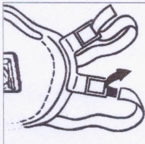
1. Treceți banda elastică din partea superioară prin catarame. Repetați pentru banda de jos și catarame. Poziționați banda elastică de jos în jurul capului chiar sub urechi. Răsuciți cureaua.
